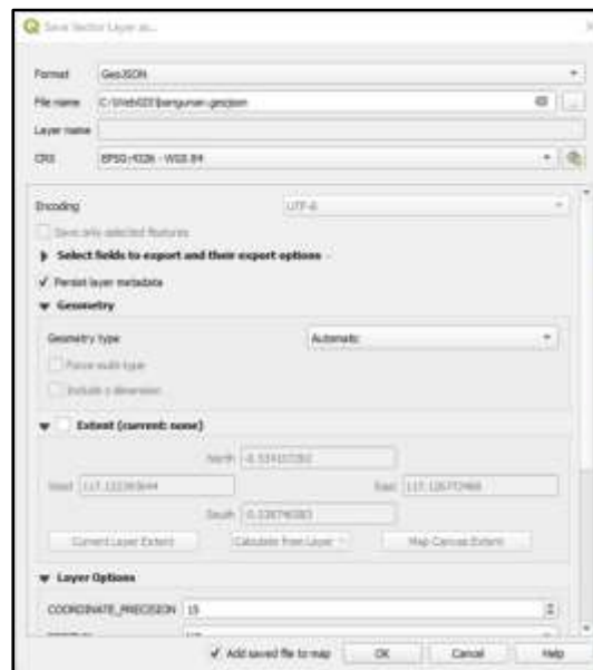
Gambar 3. Proses Konversi Data Spasial ke Format GeoJSON di QGIS
