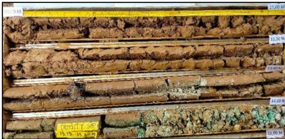
Gambar 6. Sampel endapan nikel laterit daerah penelitian pada zona saprolite
