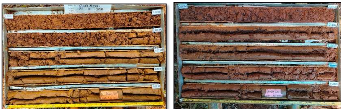
Gambar 5. Sampel endapan nikel laterit daerah penelitian pada zona limonit
