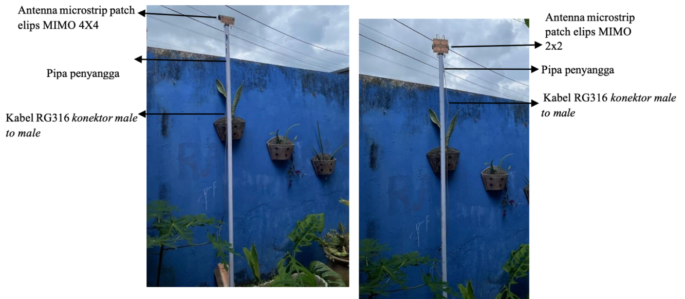
Gambar 11. Pengukuran kinerja antenna di lapangan
